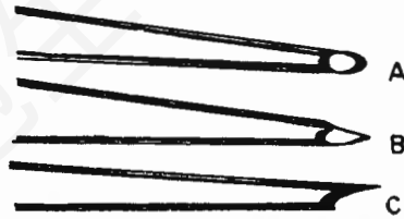
图 3 示“双磨法”磨制的微吸管尖端
